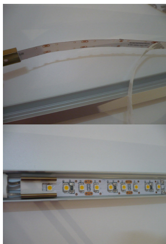
Nach kürzen des Led Bandes auf das benötigte Mass, die Folie vom Klebeband entfernen und auf das Aluprofil kleben.
