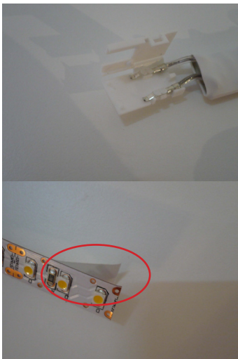
Nach Auswahl des Steuerungssystems und des LED Band Typs, den Verbinder öffnen und die Folie auf dem LED Band vom Klebeband wie abgebildet, entfernen.
