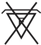
**= diese Leuchten dürfen unter keinen Umständen durch wärmedämmende oder ähnliche Stoffe abgedeckt werden!**
