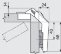
Anschlagsituation für Frontdicke 19 mm bei Verwendung einer 3 mm erhöhten Standardmontageplatte
