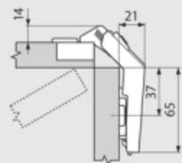
Anschlagsituation für Frontdicke 19 mm bei Werkseinstellung
