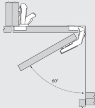
Der Topf des Faltsücharsniers wird in derselben Front wie der Topf des 170° bzw. 155°-Scharniers montiert
