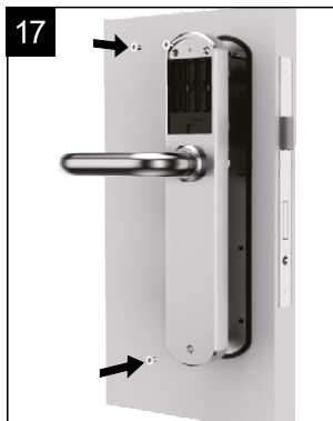
17. Upevněte zpět 3 šrouby těla vnitřního štítu.
