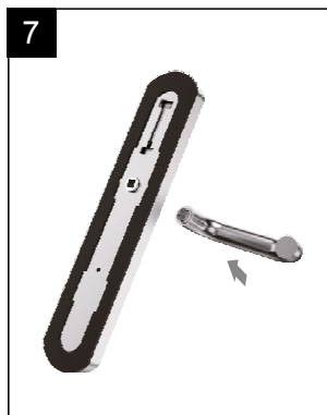
7. Kliku opětovně nasadíte po zvolení správné orientace vzhledem k otvírání dveří.
